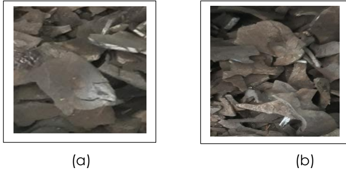
Gambar 3.1 Arang yang terarangkan (a) sempurna, (b) tidak sempurna
